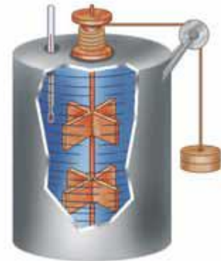
Ilustración 1: Calorímetro utilizado por Joule en el desarrollo de su experimento.
